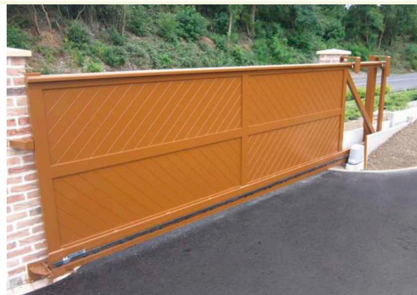
Un portail coulissant autoportant ne nécessite d'aucun rail au sol pour assurer son ouverture ou sa fermeture. Le portail n'est jamais en contact avec le sol.
