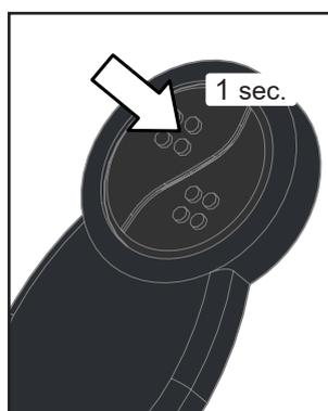
Un signal sonore retentit tant que le bouton sur la carte plug-in est maintenu enfoncé. Appuyer en même temps sur le bouton de la télécommande.
